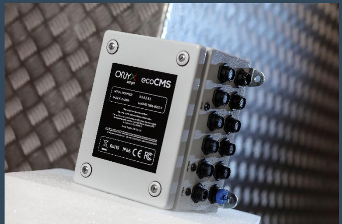
ecoCMS mit MEMS-Sensoren und fleetMONITOR liefern exakte Informationen für die Instandsetzungsplanung
